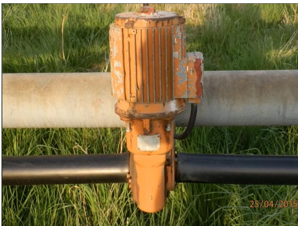
Рисунок 4 – Центральный мотор-редуктор тележки дождевальной машины Sigmatic PS
