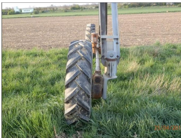
Рисунок 3 – Общий вид привода тележки дождевальной машины Sigmatic PS
