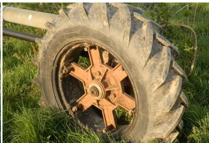
Рисунок 3 – Общий вид привода тележки дождевальной машины Sigmatic PS
