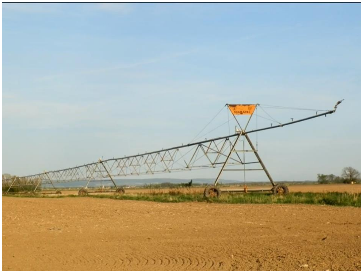
Рисунок 1 – Общий вид широкозахватной оросительной машины Sigmatic PS с развёрнутым оросительным рукавом
