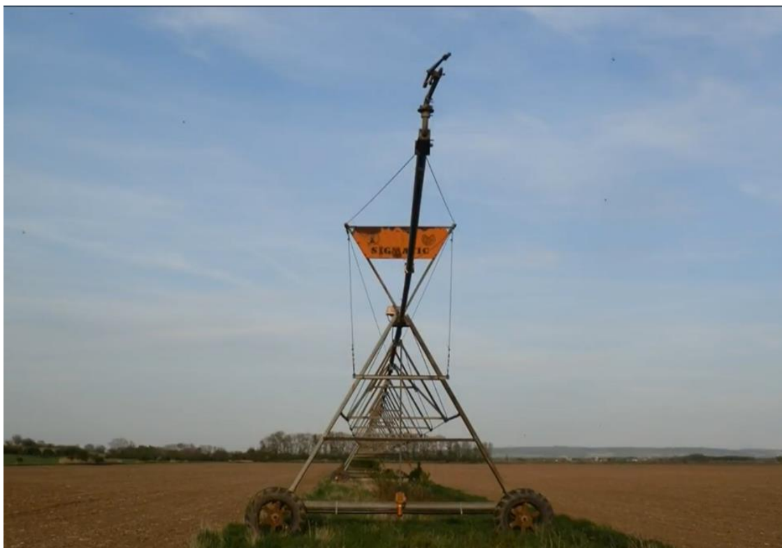
Рисунок 2 – Общий вид тележек оросительной машины Sigmatic PS
