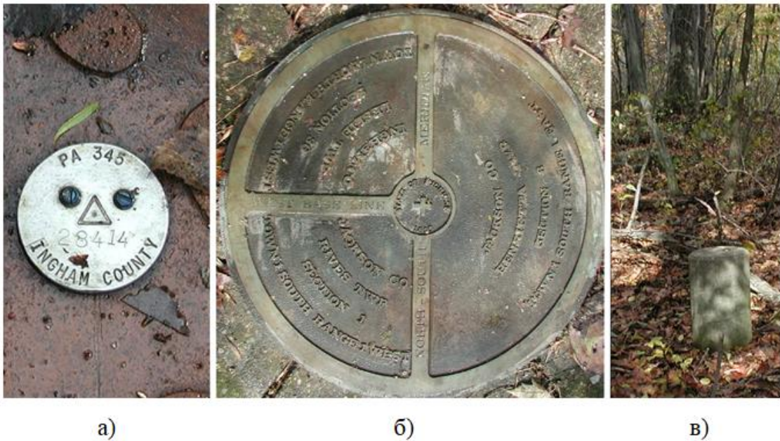
Рисунок 3. Нулевые пункты на пересечении базовых линий и Главного меридиана Мичиган: а – марка на восточном нулевом пункте; б – латунный знак над западным нулевым пунктом; в – бетонный столб обозначающий линию меридиана между восточным и западным пунктом [19]
