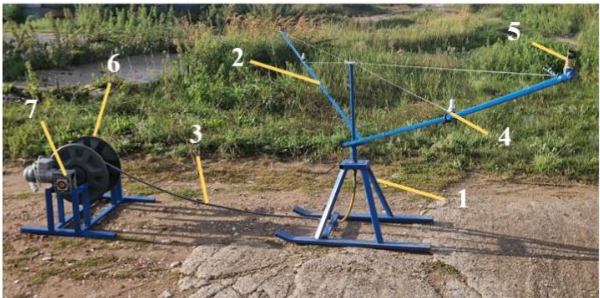
Рисунок 1 – Шланговый дождеватель с намоточным устройством 1 - опорное основание; 2 - дождевальные крылья; 3 - питающий шланг; 4 - реактивные насадки секторного действия; 5 - концевые насадки кругового действия; 6 - барабан для шланга; 7 - мотор редуктор
