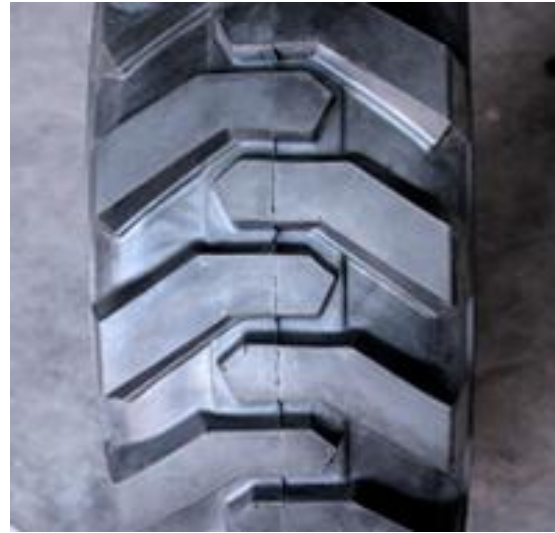
Рисунок 2. Пневматические шины с протектором типа «клюшка».
