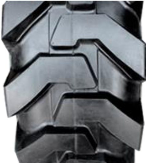
Рисунок 2. Пневматические шины с протектором типа «клюшка».
