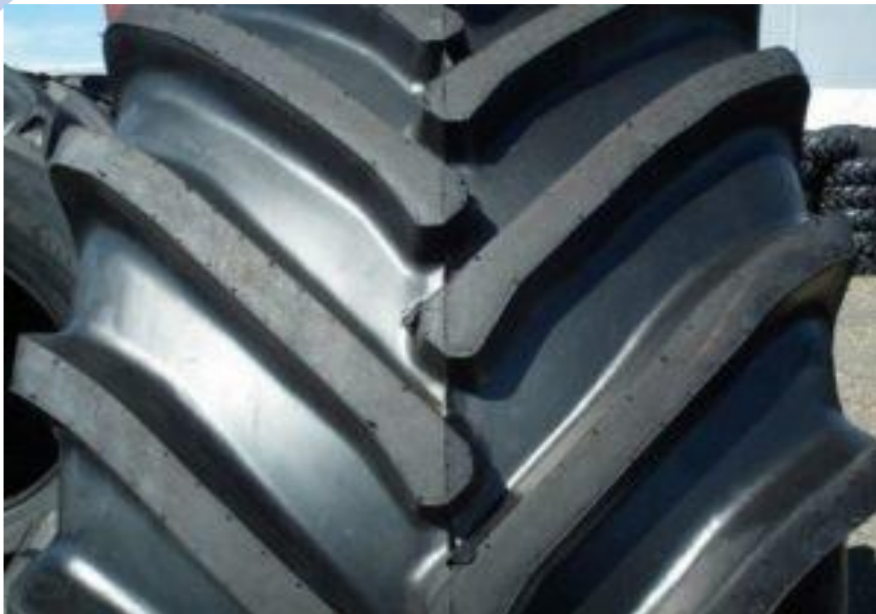
Рисунок 3. Пневмошина с протектором типа «ёлочка».
