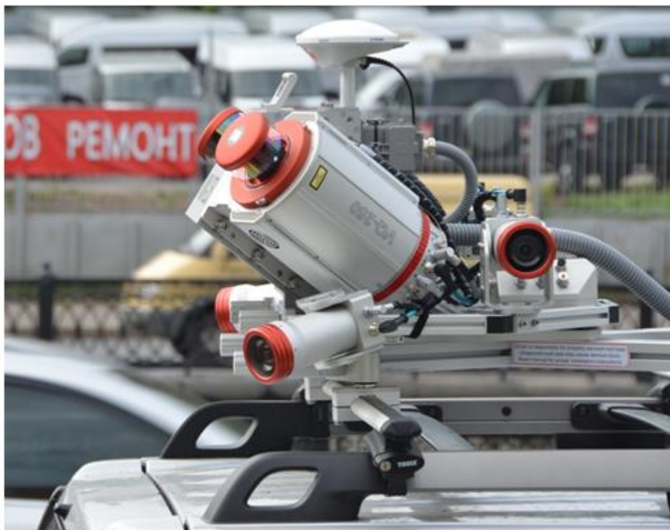
Рисунок – Мобильная сканирующая система VMX-250 на крыше автомобиля
