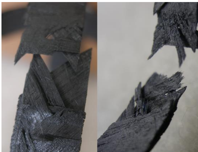
Рисунок 11 – Разрушенные фрагменты кольцевых образцов
