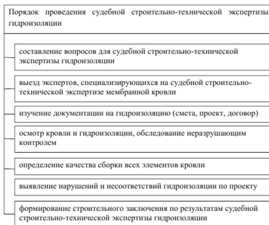
Рисунок 1 – Порядок проведения судебной строительно-технической экспертизы гидроизоляции[1]
