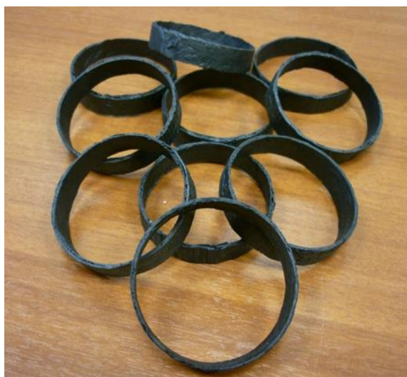
Рисунок 9 – Кольцевые образцы с укладкой (+45;-45;0;+45;-45;0;+45;-45) из ККМ SiC/SiC
