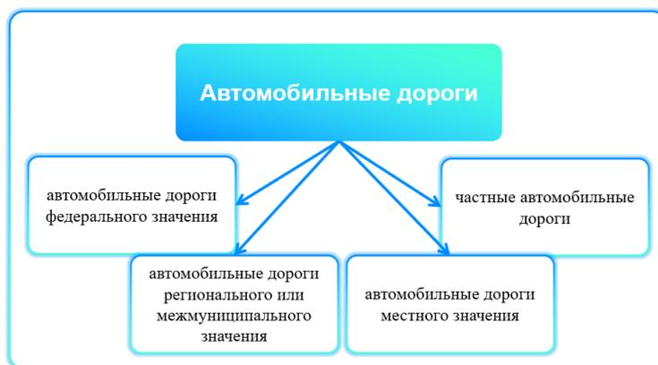
Рисунок 5 - Классификация автомобильных дорог
