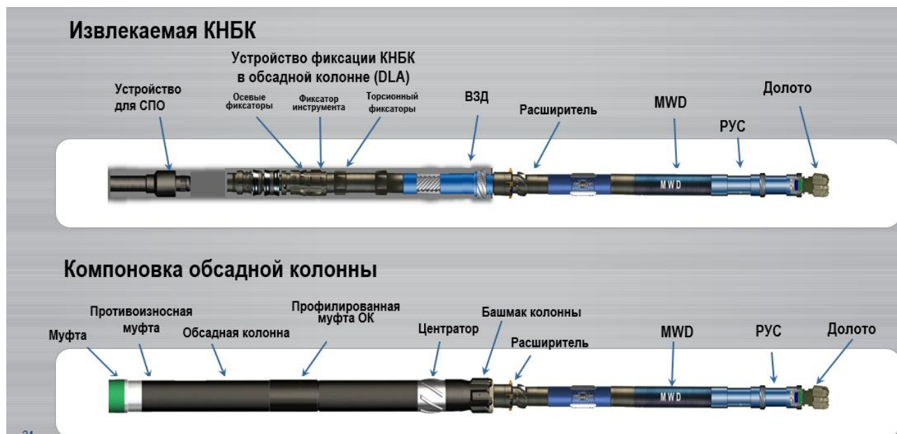
Рис. 9. КНБК для бурения CWD L3
