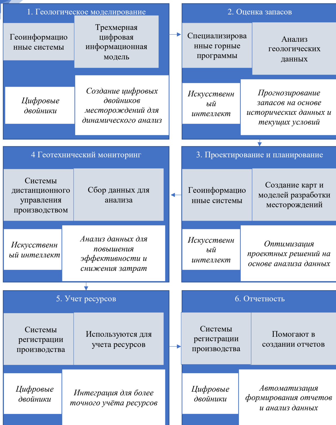
Рисунок 2. Укрупненные этапы маркшейдерско-геодезических работ и применение ИИ и ЦД
