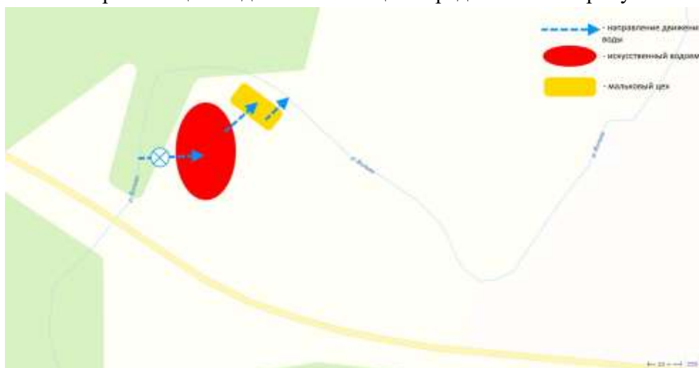
Рисунок 2 - Схема организации водоснабжения рыбоводного цеха.
