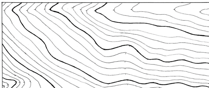
Рисунок 2. Рельеф поля 1 (2013 г., горизонтали через 10 см, масштаб 1:2000) Figure 2. Field relief 1 (2013, horizontals every 10 cm, scale 1:2000)
