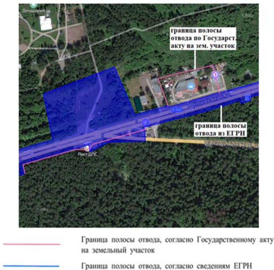
Рис. 3 – Изменение границ полосы отвода вследствие строительства магазина
