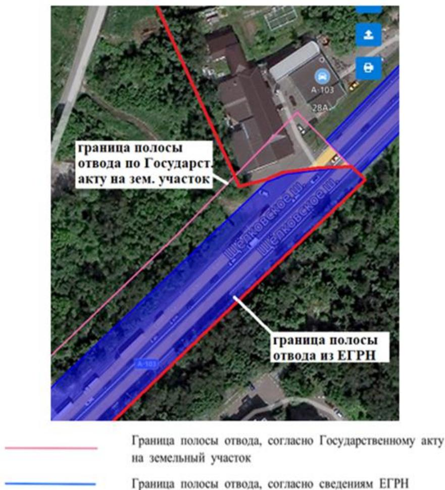
Рис. 4 – Изменение конфигурации полосы отвода автодороги по границе населенного пункта
