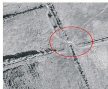
**Рисунок 5. Перекрытие каналов осушительной сети земляными дамбами по материалам АФС**
