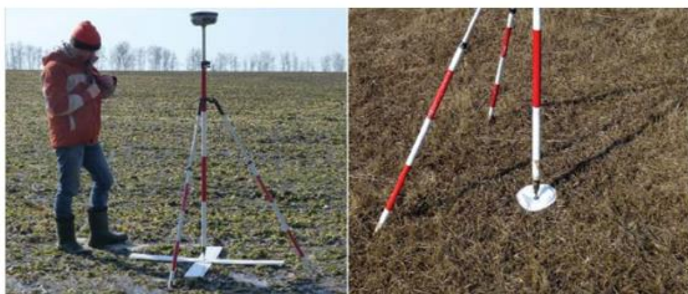
Рисунок 8 – Общий вид полигона с пунктами планово-высотного обоснования
