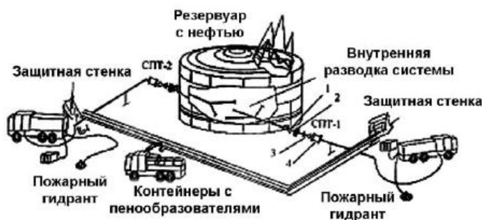
Рисунок 1. Схема подачи пены низкой кратности при тушении пожара в резервуаре подслоным способом. 1- задвижка, 2 – мембрана предохранителя, 3 – обратный клапан, 4 – пеногенератор
